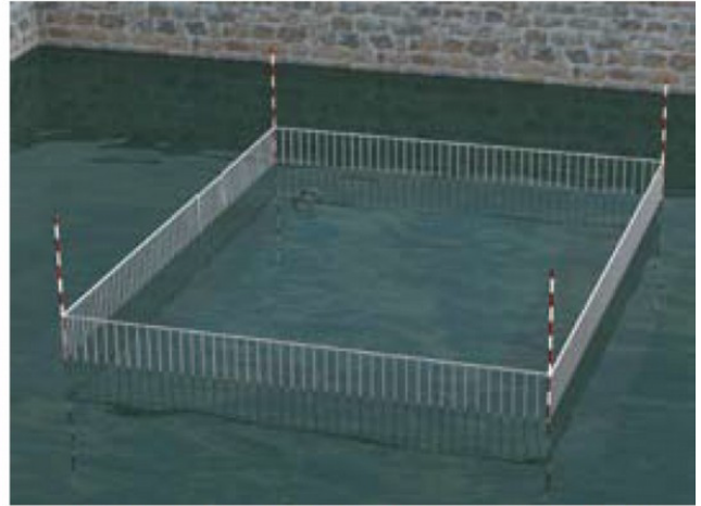
La barrière de sécurité reste visible tant que le niveau de l'eau est inférieur à sa hauteur
